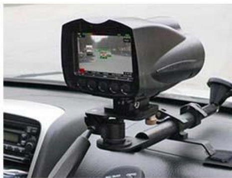
Рис.3 Измеритель скорости движения транспортных средств с видеофиксацией «Бинар»
